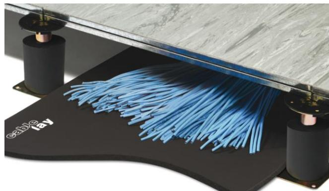
Rohože jsou určeny pro instalaci přímo na podlahu. Díky „uzavřeným buňkám“ zabraňuje vzlínání vody a vlhka zejména při havárii vody, např. prasklým radiátorem apod. Pro tento případ jsou dodávány rohože v různých tloušťkách – 6mm, 13mm či 25mm. Na přání jsou rohože vyráběny i ve větších tloušťkách. Kabely a kabelové svazky se ukládají přímo na rohože a odpadá tak nutnost ukládat kabely do žlabů. Díky snadné a bezhlubné instalaci pak umožňují přípravu tras kdykoliv bez ohledu na čas.
